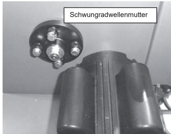
Um den Antriebsriemen auszutauschen, muss das untere Laufrad entfernt werden.
